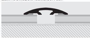
1. Scegliere il SOL 30 adesivo della finitura desiderata. 2. Tagliare il profilo alla lunghezza richiesta e pulire, sgrassare e asciugare il piano verificando che la temperatura di applicazione non sia inferiore a 15°. 3. Rimuovere la carta protettiva dell'adesivo e posare il profilo correttamente con una pressione verticale manuale uniforme senza muovere il profilo e senza l'utilizzo di martelli in ferro/acciaio.
