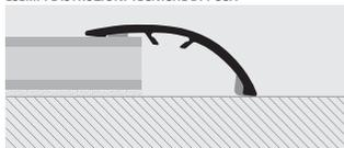
1. Scegliere il ZERO CURVE adesivo della finitura desiderata. 2. Tagliare il profilo alla lunghezza richiesta e pulire, sgrassare e asciugare il piano verificando che la temperatura di applicazione non sia inferiore a 15°. 3. Rimuovere la carta protettiva dell'adesivo e posare il profilo correttamente con una pressione verticale manuale uniforme senza muovere il profilo e senza l'utilizzo di martelli in ferro/acciaio.
